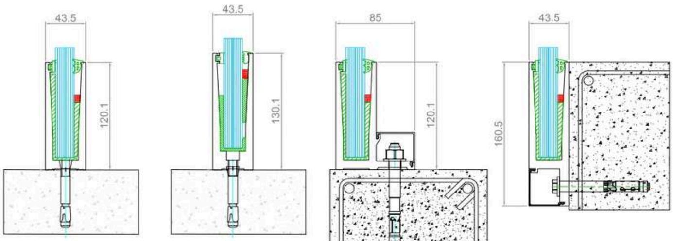
**Secciones:** Perfil en U con sección de 43.5 mm y 120 mm de altura, con posibilidad de tapeta exterior para anclaje lateral oculto
